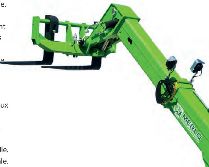
Le tablier est muni du dispositif de blocage hydraulique Tac-lock qui assure un changement rapide de l'accessoire dans le plus grand confort.
