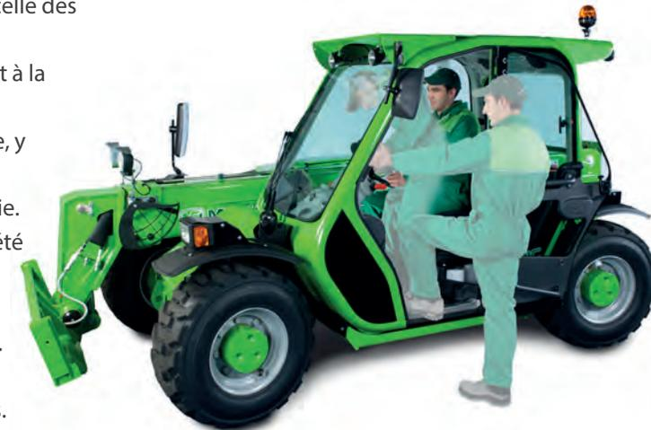
Le conducteur accède naturellement au poste de conduite, grâce à la distance optimale entre le siège et le volant, ainsi qu'à la large portière vitrée constituée de deux éléments s'ouvrant tous les deux à 180°.
