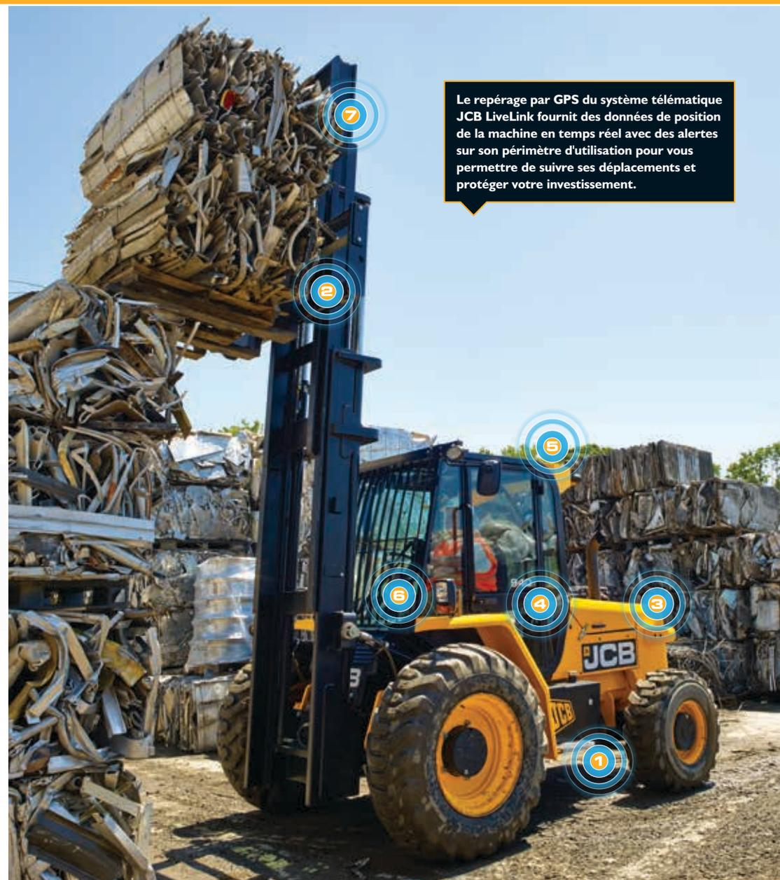
Le repérage par GPS du système télématique JCB LiveLink fournit des données de position de la machine en temps réel avec des alertes sur son périmètre d'utilisation pour vous permettre de suivre ses déplacements et protéger votre investissement.
