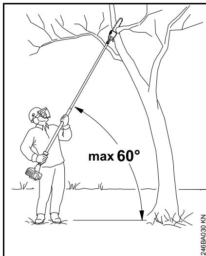
Tenere l'apparecchiatura obliquamente; non stare direttamente sotto il ramo da tagliare. Non superare un angolo di 60° rispetto al piano orizzontale. Fare attenzione al legno che cade.
