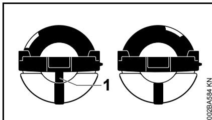
À g. : La partie inférieure du bouchon du réservoir est décalée – le marquage intérieur (1) coïncide avec le marquage extérieur.
