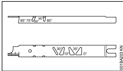
Calibro STIHL per lima (a richiesta; ved. tabella "Attrezzi per affilatura") – un attrezzo universale per controllare gli angoli di affilatura e di spoglia anteriore, la distanza del limitatore di profondità, la lunghezza del dente, la profondità della scanalatura, e per pulire la scanalatura e i fori di entrata dell'olio.
