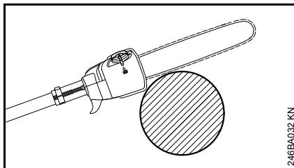
Beim Trennschnitt die Schiene im Bereich des Hakens am Ast zur Anlage bringen. Dies vermeidet ruckartige Bewegungen des Motorgerätes bei Beginn des Trennschnittes.
