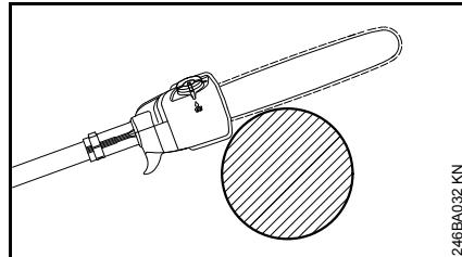
Het zaagblad bij de haak tegen de tak plaatsen en de zaagsnede aanbrengen. Dit voorkomt schokachtige bewegingen van het motorapparaat bij het begin van de zaagsnede.
