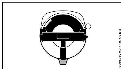
In deze stand staan de markeringen op de tankdop en de olietank met elkaar in lijn
