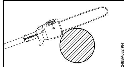
Het zaagblad ter hoogte van de behuizing tegen de tak plaatsen en de zaagsnede van boven naar beneden aanbrengen – voorkomt het inklemmen van de zaagketting in de zaagsnede.
