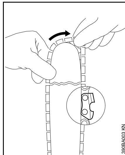
am Spannschieber legen – gleichzeitig die Sägekette über das Kettenrad (5) legen
