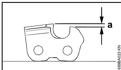
Il limitatore di profondità determina la profondità di penetrazione nel legno, quindi lo spessore del truciolo.
