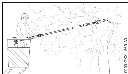
L'ampio raggio d'azione permette di tagliare i rami direttamente sul tronco senza danneggiarne altri con la piattaforma. L'angolo d'incidenza dipende dalla posizione del ramo.
