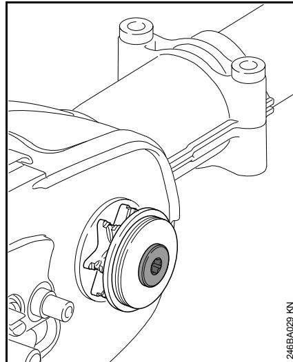
Das Kettenrad wird über eine Rutschkupplung angetrieben. Der Kettenradwechsel muss von einem Fachhändler ausgeführt werden.
