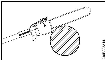
Die Schiene im Bereich des Gehäuses am Ast zur Anlage bringen und Trennschnitt von oben nach unten ausführen – vermeidet Klemmen der Säge im Schnitt.
