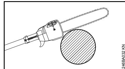
Pour exécuter la coupe de séparation, appliquer le guide-chaîne de telle sorte que le crochet se trouve tout près de la branche. Cela évite que la machine soit soumise à des mouvements brusques au commencement de la coupe de séparation.
