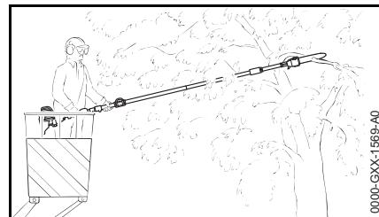
Door de grote reikwijdte kunnen takken direct op de stam worden afgezaagd zonder daarbij andere takken met de hoogwerker te beschadigen. De aanzethoek is afhankelijk van de stand van de tak.
