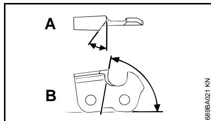
De plus, toutes les dents de la chaîne doivent présenter les mêmes angles. En cas d'angles inégaux : fonctionnement irrégulier et par à-coups, usure plus rapide – jusqu'à la rupture de la chaîne.
