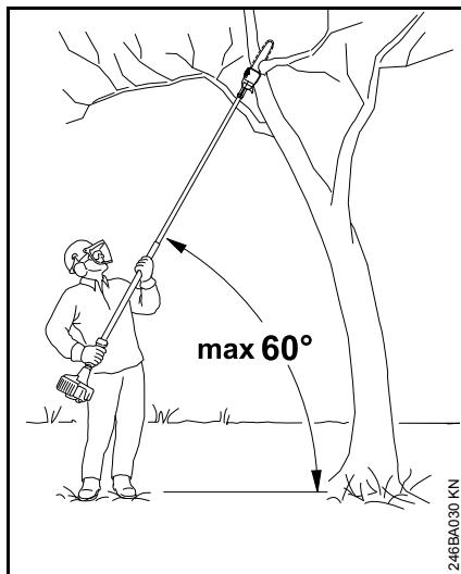
Het motorapparaat schuin houden, niet direct onder de af te zagen tak staan. Een hoek van 60° ten opzichte van de grond niet overschrijden. Op vallend hout letten.
