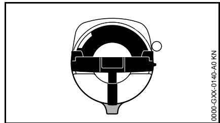
Après cela, les repères du réservoir à huile et du bouchon du réservoir coïncident.
