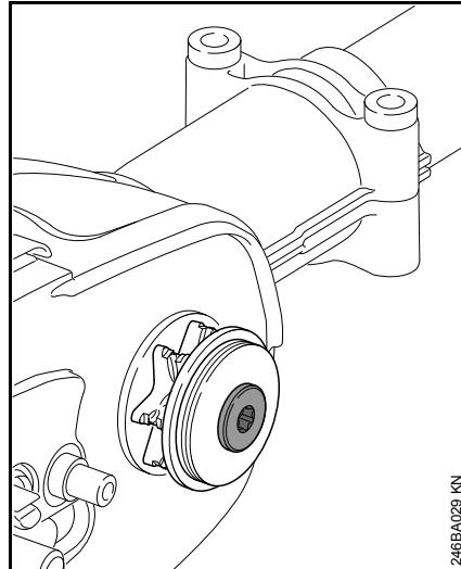
Het kettingtandwiel wordt via een slipkoppeling aangedreven. Het vervangen van het kettingtandwiel moet worden uitgevoerd door een STIHL dealer.
