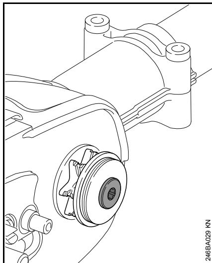
Le pignon est entraîné par un embrayage à friction. Le remplacement du pignon de chaîne doit être effectué par un revendeur spécialisé.
