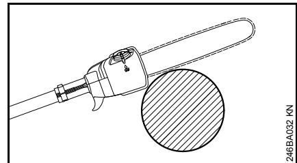
Appoggiare la spranga con la carcassa sul ramo ed eseguire il taglio di sezionamento dall'alto in basso – per impedire che la spranga si blocchi nella fenditura.
