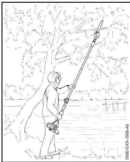
Grâce à la grande portée du tube, il est également possible de couper des branches au-dessus d'obstacles, par ex. au-dessus de l'eau. L'angle du tube dépend alors de la position de la branche.
