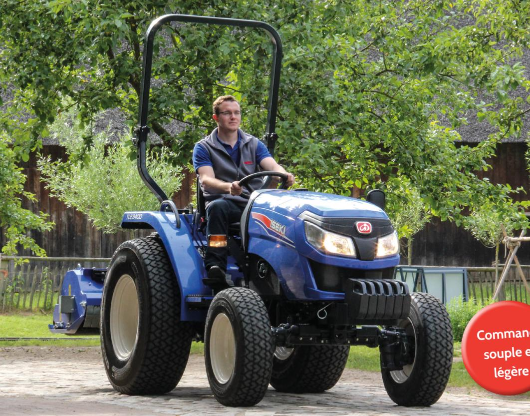
La série Iseki TLE se compose de 2 modèles: le TLE3400 avec entraînement hydrostatique à 3 groupes et le TLE4490 avec transmission mécanique avec 8 vitesses avant et 8 arrières.
