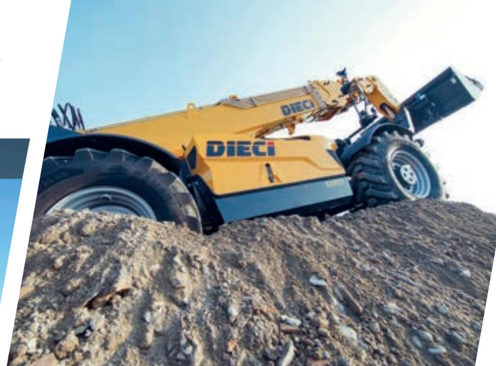
Icarus Dynamic, qui fait partie de la Nouvelle Gamme BTP, est la machine qui voit haut : le bras se déploie **jusqu'à 18 mètres** tout en conservant un **équilibre parfait** grâce aux stabilisateurs indépendants à commande proportionnelle.
