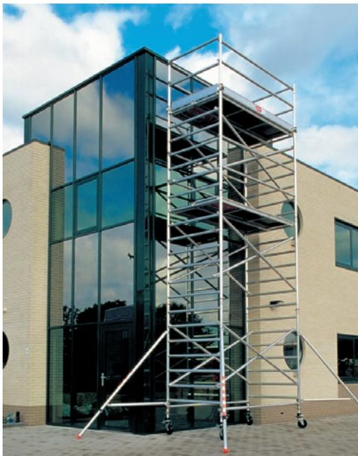
Avec son vaste plancher large de 1,35 m disponible en trois longueurs: 1,85 m - 2,45 m - 3,05 m et sa hauteur maximale de travail à l'intérieur de 14 m et à l'extérieur de 10 m font que la série 5200 offre d'innombrables applications sur vos chantiers. La distance entre ses barreaux de 280 mm rend l'accès au plancher sûr et confortable.
